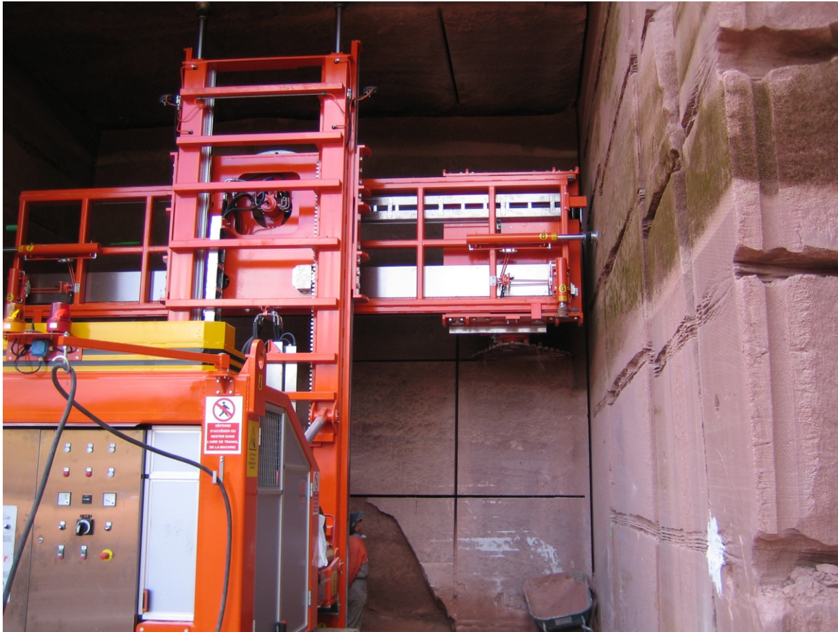
PUNTELLI IDRAULICI (AUTOSTABILIZZANTI) HYDRAULIC JACKS (AUTO-STABILIZING)
