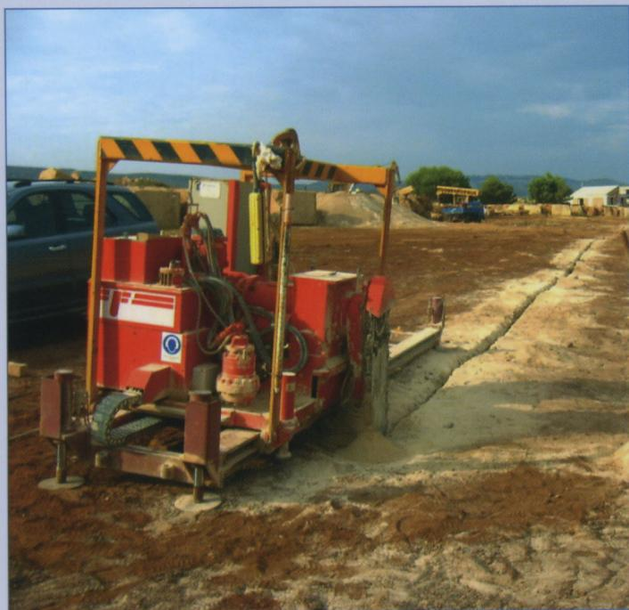
■ Tous les deux modèles peuvent être équipés avec l'actionnement électrique de la chaîne à 2 vitesses (version EL/ID: I-II) ou hydraulique à vitesse variable (version ID: ▲).
