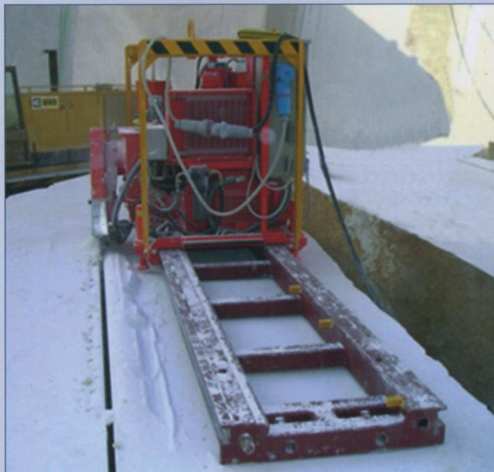
Entrambi i modelli possono essere equipaggiati con azionamento catena elettrico a 2 velocità (versione EL/ID:I-II) oppure idraulico a velocità variabile (versione ID:▲).
