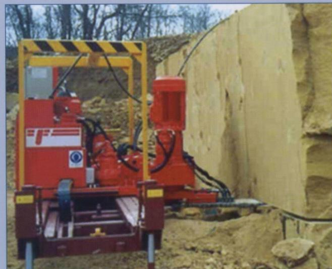
■ Il Modello 50.90-BU utilizza un binario unico auto-traslante che permette ampia autonomia di spostamento.
