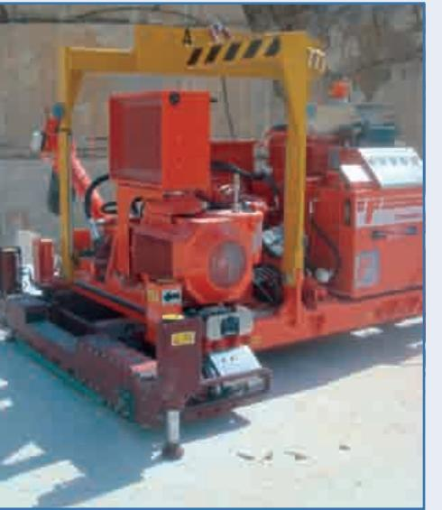
**Il modello 70 RA-BU** utilizza un binario unico auto-traslatore che permette ampia autonomia di spostamento e di limitare l'uso dei mezzi di sollevamento
