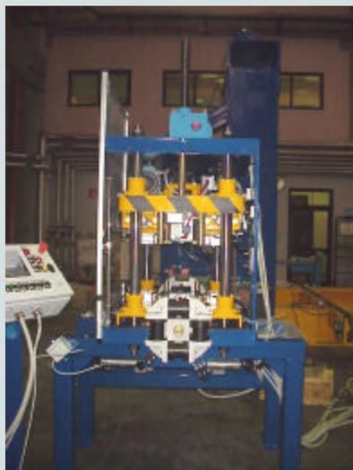
Sulla zona superiore della piastra mobile è posizionata la motorizzazione per la traslazione dei due gruppi di rifilatura bandelle posizionati al di sotto della piastra stessa.
