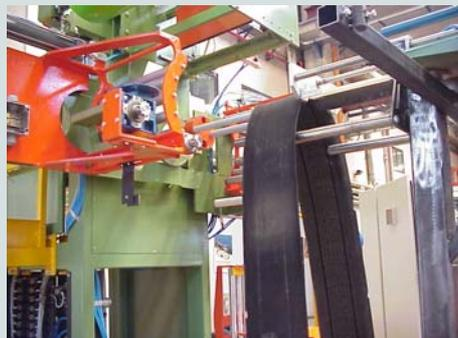
L'espulsore provvede a spingere l'anello di gomma sulle forche dell'avvolgitrice che, ricevuto il prodotto, si mettono in rotazione determinando la formazione dell'involto.
