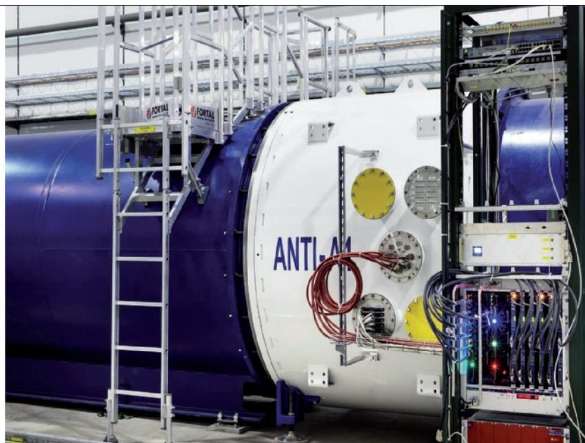
NA62 è un tubo lungo 270 m, all'interno del quale, grazie a delle potenti pompe, viene mantenuto un alto vuoto (10<sup>-6</sup> mbar).
