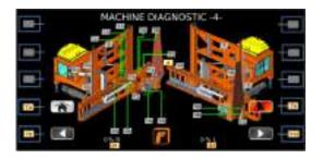
THE GU 70 SPECIAL IS MANAGED BY A SINGLE OPERATOR THE COLOR DISPLAY RIGHT ON THE BACK, SHOWS YOU A WIDE RANGE OF SETTINGS AND PARAMENTERS. THE AUTOMATIC CUT ALLOWS THE OPERATOR, ONCE THE PARAMETERS HAVE BEEN SET, TO PERFORM IT IN A TOTALLY AUTOMATIC WAY, FROM THE BEGINNING TO THE END.
